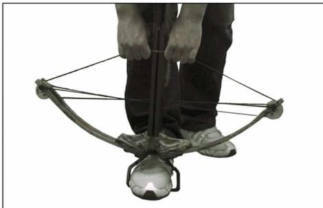
Platzieren Sie Ihren Fuß sicher im Fußbügel. Greifen Sie über den Schaft und erfassen Sie die Sehne fest an beiden Seiten der Führungsschiene. Benutzen Sie Ihre Daumen, um an den Seiten des Laufs entlang automatisch die Sehnen während des Spannens zu zentralisieren. Zu einseitiges Spannen der Armbrust wird sich ungenau auswirken und links- oder rechtsseitige Orientierung nach sich ziehen.
