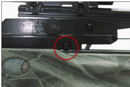
Stellen Sie den Sicherungshebel vorm Spannen immer auf Fire-Position. Ziehen sie den Abzug um zu überprüfen, ob er bereit ist, die Sehne aufzunehmen. Falls sich der Abzug nicht bewegt, ist die Sicherung noch eingestellt und die Sehne kann nicht einrasten. Der Abzug wird sich also nicht spannen, falls die Sicherung noch in der Safe-Position ist. Nach dem Spannen wird die Sicherung automatisch aktiviert.
